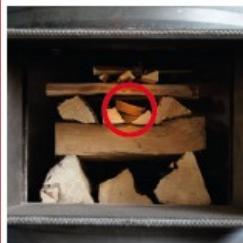
ca. 5 kg trockenes Holz kreuzweise in den Feuer- raum schichten, Anzünder positionieren und Feuer- tür nach dem Entzünden schließen
